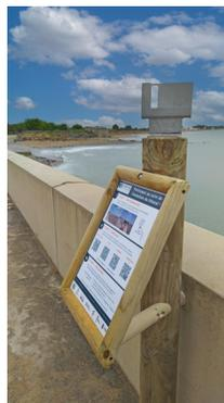
**En couverture** : Exemple de support inox mis en place pour la prise de photographies par smartphone dans le cadre du dispositif CoastSnap (ici à la plage des Homardiers, Île de Noirmoutier)
