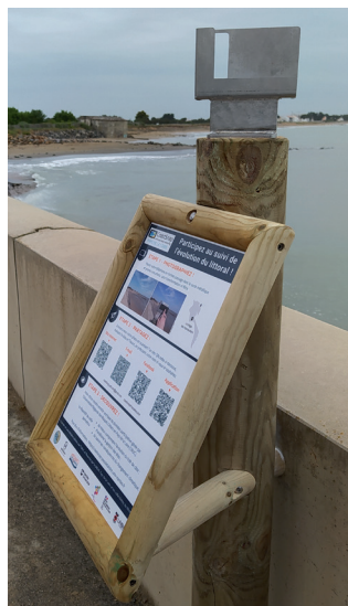
Figure 1 - Le dispositif CoastSnap, les sites instrumentés sur le littoral des Pays de la Loire et leurs caractéristiques
